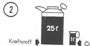
b. Tank mit Zweitakt-Gemisch füllen (Abb.3). Möglichst saubere Gefäße und Siebtrichter benutzen, um Verschmutzung von Tank und Vergaser zu vermeiden, was sonst Motorstörungen und Ärger durch notwendige Säuberungsarbeiten mit sich bringt.
