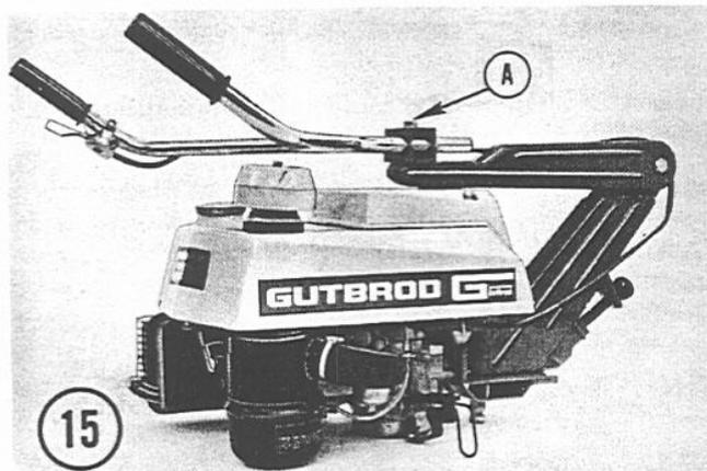
Tragstellung (Abb. 15). Um den Antriebsblock leichter von einem Zusatzgerät zum anderen tragen zu können, lässt sich der Führungsholm nach vorn über den Motor umklappen. (Dazu Knebelschraube "A" (Abb. 14) lockern, Führungsholm umklappen, Knebelschraube wieder anziehen).
